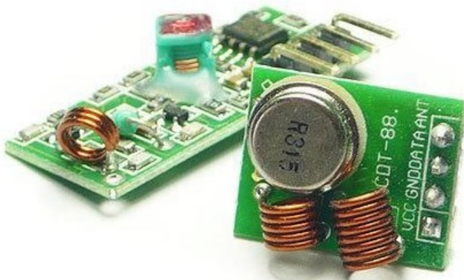
Fig. 30: módulo transmisor (derecha) y receptor (izquierda) a 433 MHz
