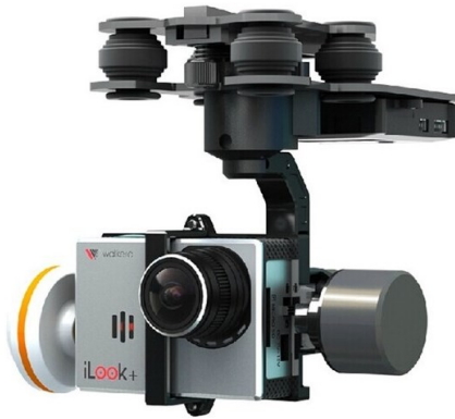
Fig. 15. Cámara con Gimbal acoplado.
