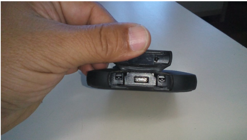
Fig. 28. Puerto USB micro-B de cámara FLIR C2.
