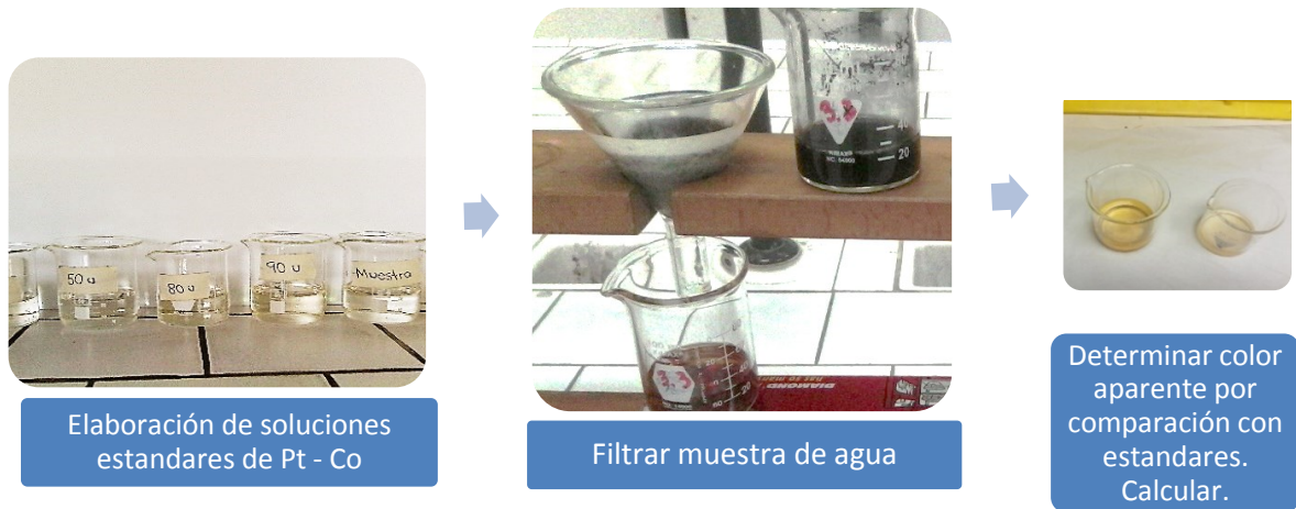
Figura 17. Determinación de color por el método de platino cobalto. Fuente: Elaboración propia.
