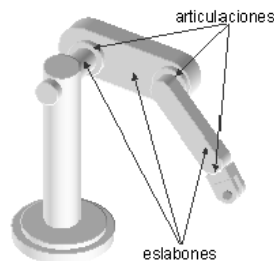
Ilustración 2: Morfología de un robot y tipos de articulaciones. Imagen obtenida de
