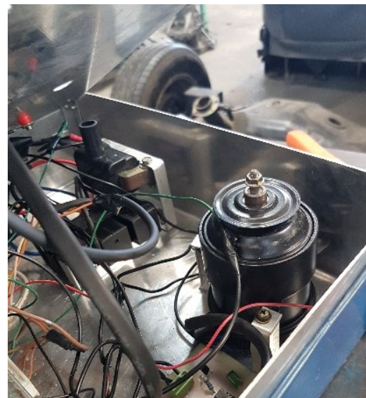
Instalación de bobina de encendido para prueba de módulos electrónicos.
