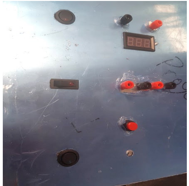
Instalación de interruptores y puntos de prueba en estuches de aluminio.
