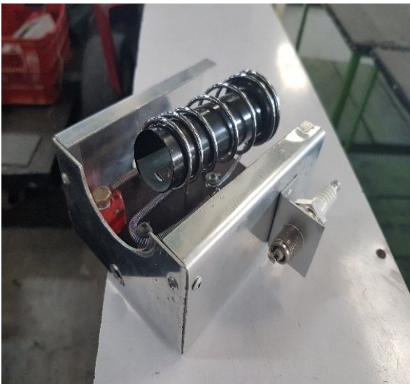
Instalación de bujía de prueba en calentador de bobinas para optimizar espacio.
