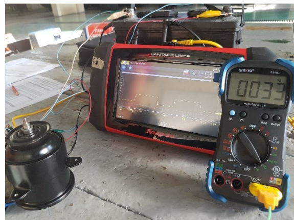
Prueba de etapas de trabajo del motor eléctrico 12 voltios
