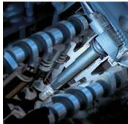
Las bobinas de encendido con receptáculo están montadas en el fondo del compartimiento del motor y deben soportar cargas térmicas extremas.
