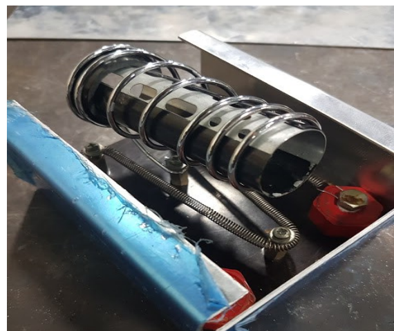
Diseño y elaboración de circuito calentador de bobinas de encendido tipo DIS
