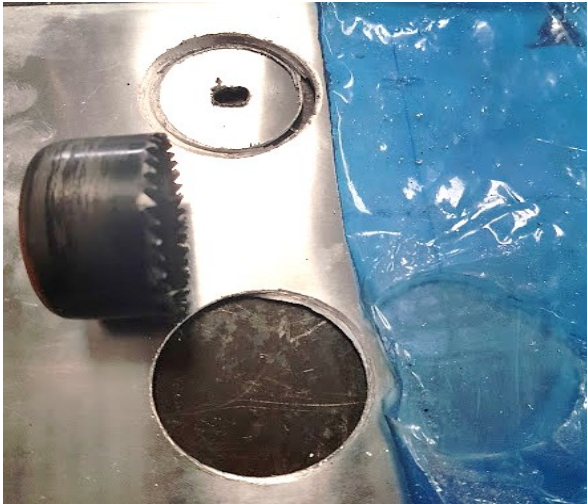
Proceso de cortes circulares para instalación de marcadores en estuches de aluminio
