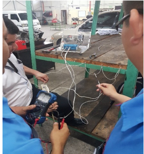
Realización de pruebas en componentes a utilizar para circuito calentador de bobinas.
