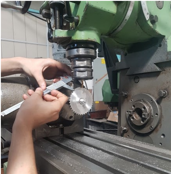
Diseño y construcción de reluctor para motor eléctrico. (Colaboración de Ing. Luis Cedillos)
