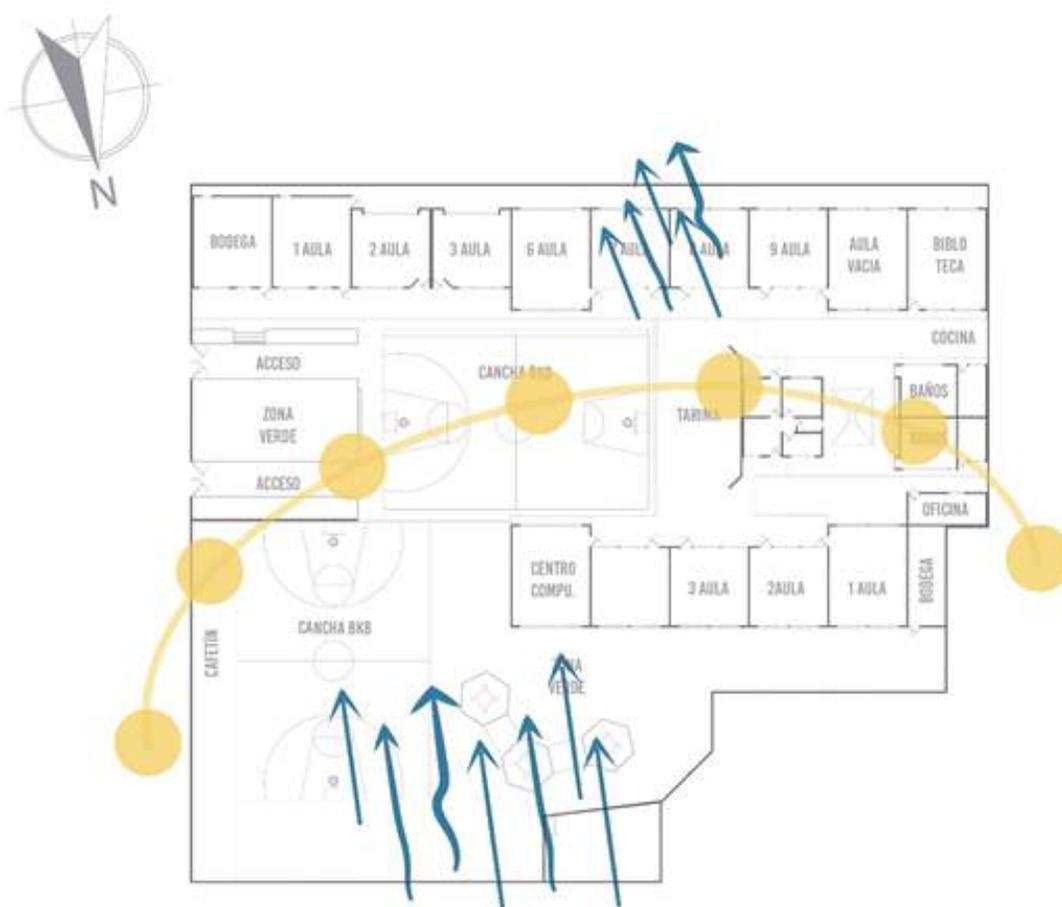
Imagen 23. Esquema Asoleamiento y ventilación C.E. Quezaltepec. Realizado por los autores
