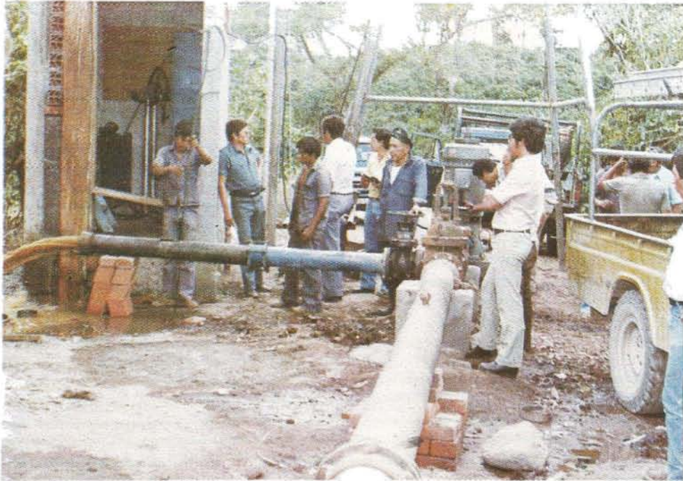
POZO ESPINO N° 5. NOTESE LA TURBIEDAD DEL AGUA, AL INICIO DE LA PRUEBA.
