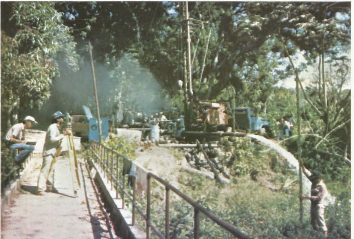
Prueba de aforo y levantamiento topográfico realizados en Planta de Bombeo El Cacahuatal en Cojutepeque.
