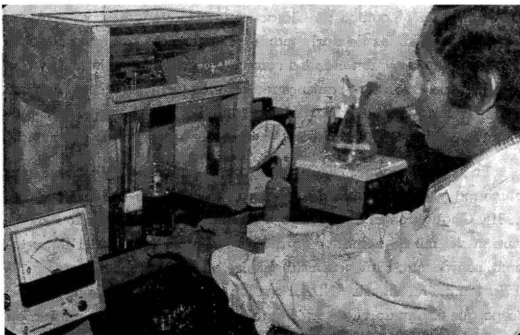
En esta fotografía captamos los momentos en que el Lic. Héctor Alfredo Dueñas, Ecotecnólogo del Depto. Opera la Balanza analítica eléctrica, que se utiliza para pesar los diferentes reactivos para preparar las soluciones que sirven para determinar el análisis del agua.
