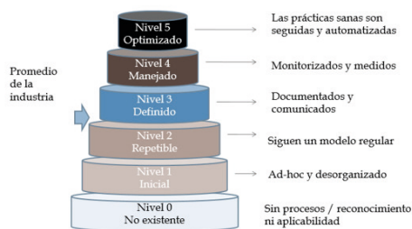
Figura n.º 8. Modelo de madurez basado en Capability Maturity Model del Software Engineering Institute SEI de la Universidad Carnegie – Mellon.
