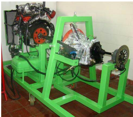
Figura 1. Banco probador de transmisiones automáticas en proceso final de innovación.
