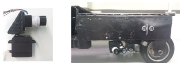
Figura 10. Izquierda: Sensor LIDAR con Servomecanismo. Derecha: LIDAR instalado en el AGV.
