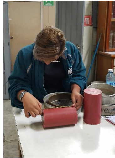
Figura 35. Medición de cilindros de plástico reciclado.
