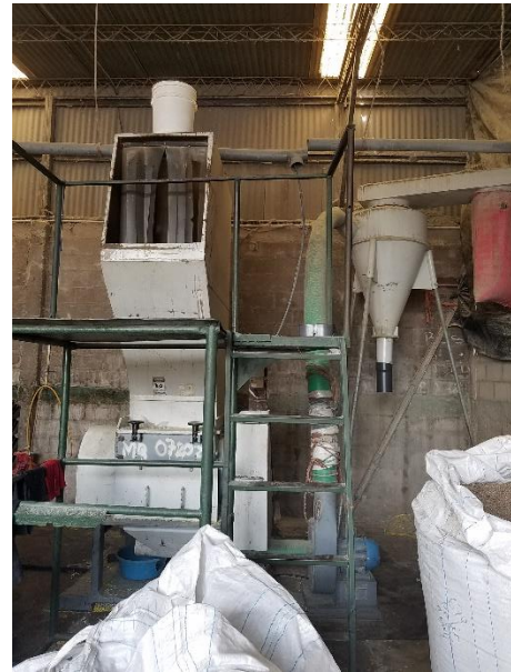
Figura 5 y 6. Las bandas llevan la materia prima a maquinas trituradoras de plástico.
