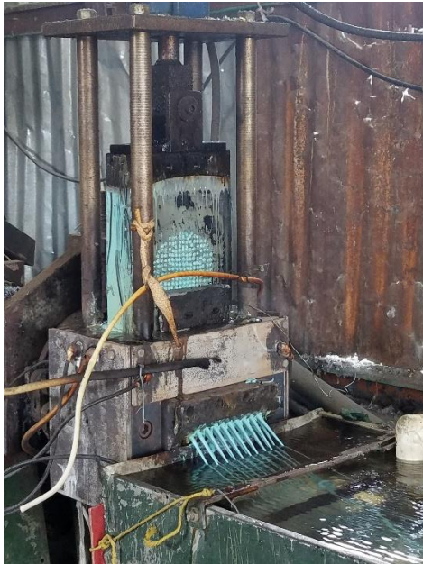
Figura 13 y 14. Al final de la máquina extrusora hay una boquilla con orificios por donde sale el plástico en forma de filamentos, que se sumergen en una pileta de agua fría para lograr enfriarlos y solidificarlos.
