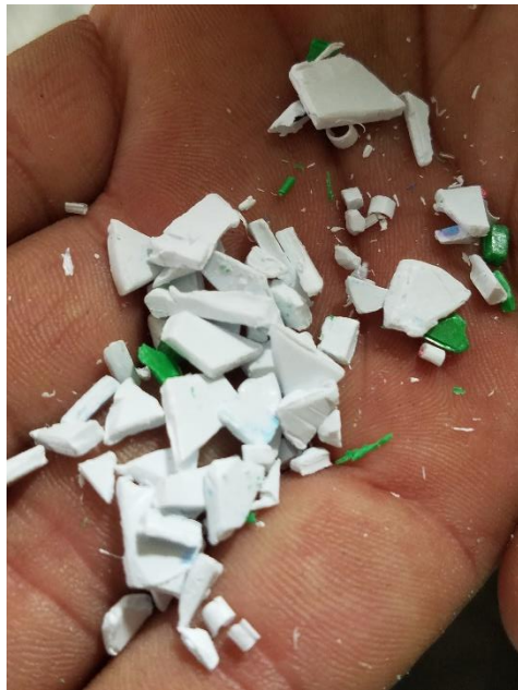
Figura 7 y 8. De la trituradora salen partículas no uniformes, las cuales deben ser lavadas, y para ello reutilizan en agua que se ocupan en los diferentes procesos.
