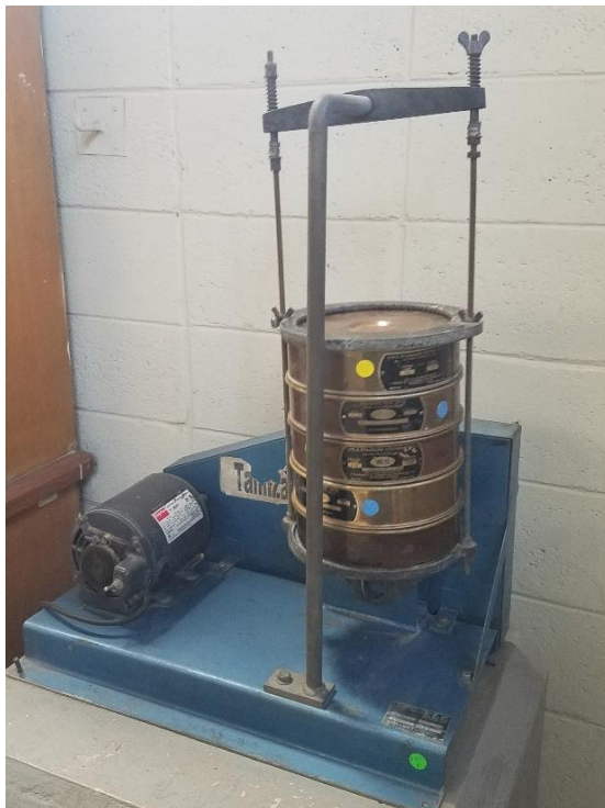
Figura 19. La muestra se coloca en el tamizador por un tiempo determinado en la norma.
