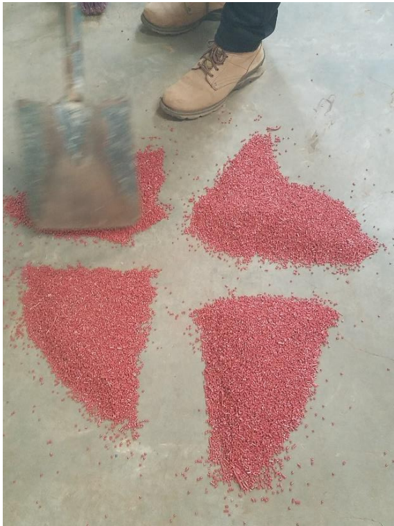
Figura 17. Cuarteo de material a analizar.
