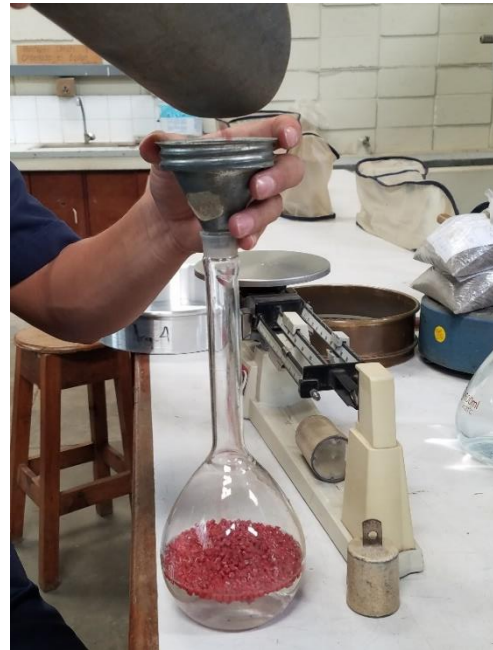
Figura 27. Luego se agrega agua y material al picnómetro.
