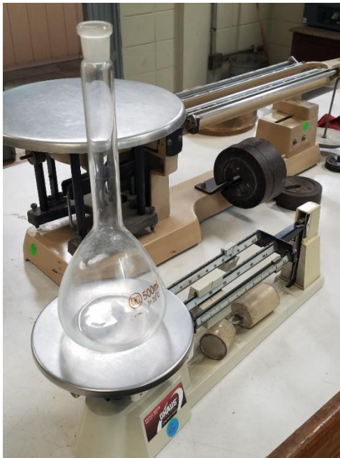
Figura 26. Se pesa el picnómetro seco y vacío.
