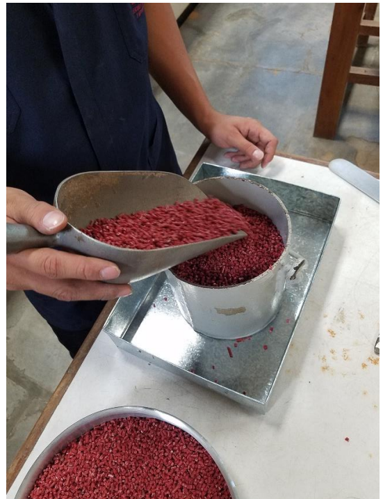
Figura 23. Colocación de material plástico al molde.
