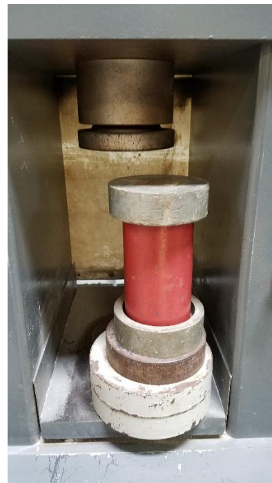
Figura 37. La máquina de compresión registra la carga aplicada la probeta, en el caso del plástico polietileno, la probeta no sufrió rupturas, solo una deformación en vertical y horizontal.
