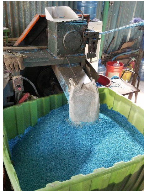
Figura 15 y 16. Al enfriarse pasan por otra máquina que corta los filamentos para dejar el plástico en forma de pellet, y estos son guardados en sacos para su distribución a los diferentes compradores.
