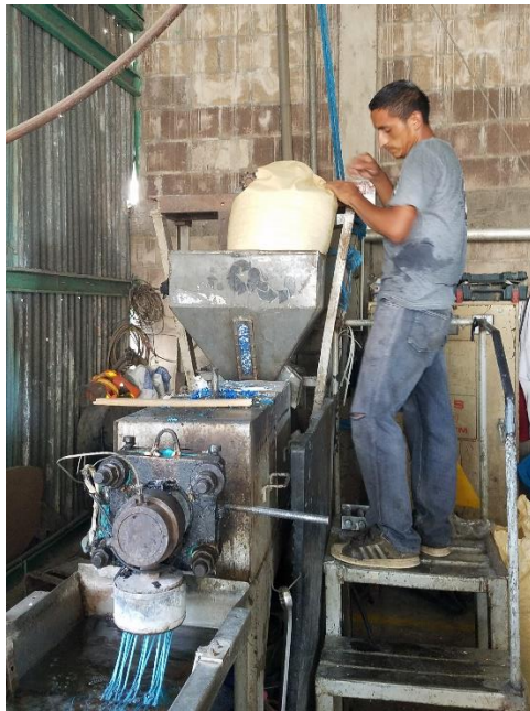
Figura 11 y 12. Cuando se ha secado el material, se lleva a la fase en la que se vierte en una tolva el plástico picado y luego va pasando por un tornillo sin fin en una maquina extrusora, a una alta temperatura que logra fundir el plástico.
