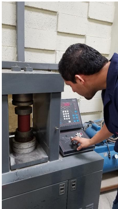
Figura 36. La probeta obtenida de plástico, se coloca en la máquina de compresión para aplicarle la carga con una carga y velocidad continua.
