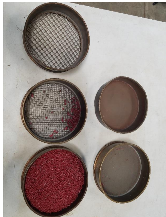
Figura 20. Material retenido en las diferentes mallas.
