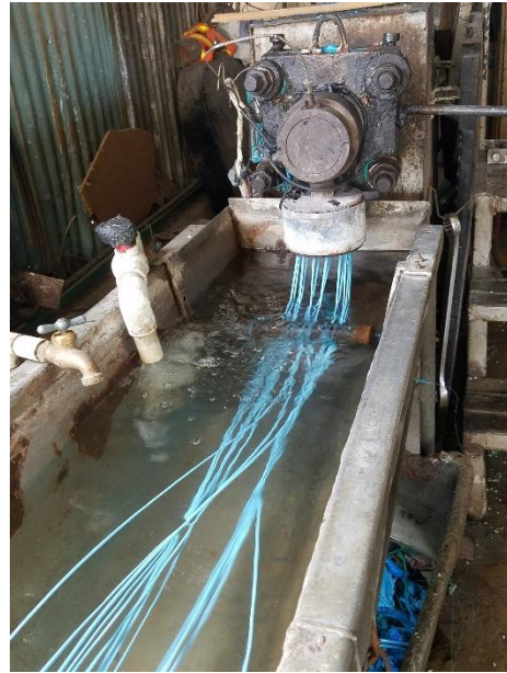
Figura 13 y 14. Al final de la máquina extrusora hay una boquilla con orificios por donde sale el plástico en forma de filamentos, que se sumergen en una pileta de agua fría para lograr enfriarlos y solidificarlos.
