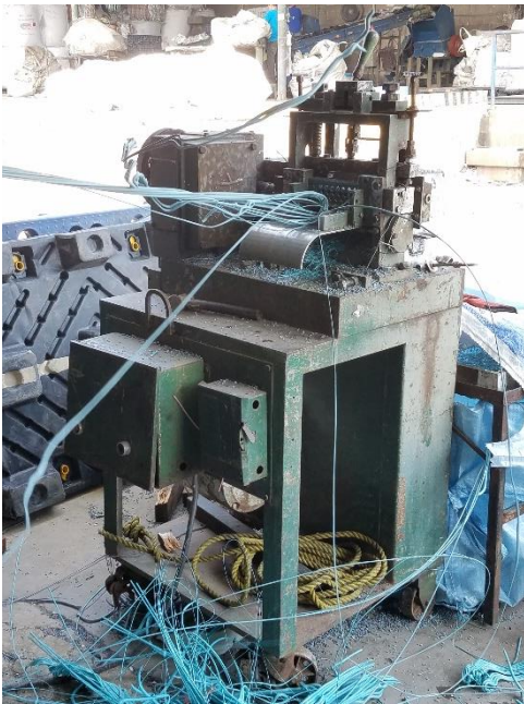
Figura 15 y 16. Al enfriarse pasan por otra máquina que corta los filamentos para dejar el plástico en forma de pellet, y estos son guardados en sacos para su distribución a los diferentes compradores.
