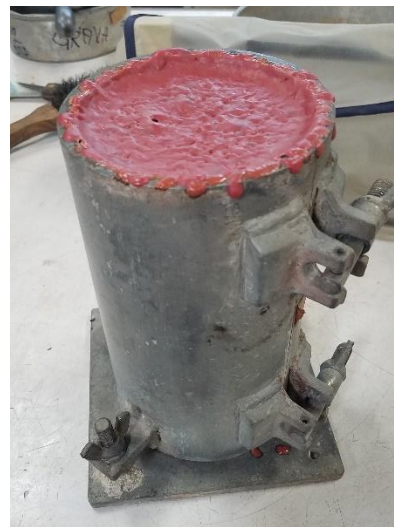
Figura 33. Plástico fundido dentro del molde.
