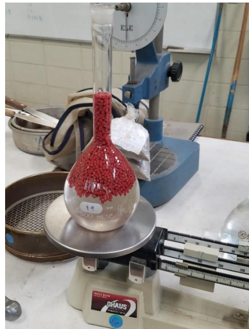
Figura 29. posteriormente se vuelve a pesar el picnómetro con el agua y el material e su interior.
