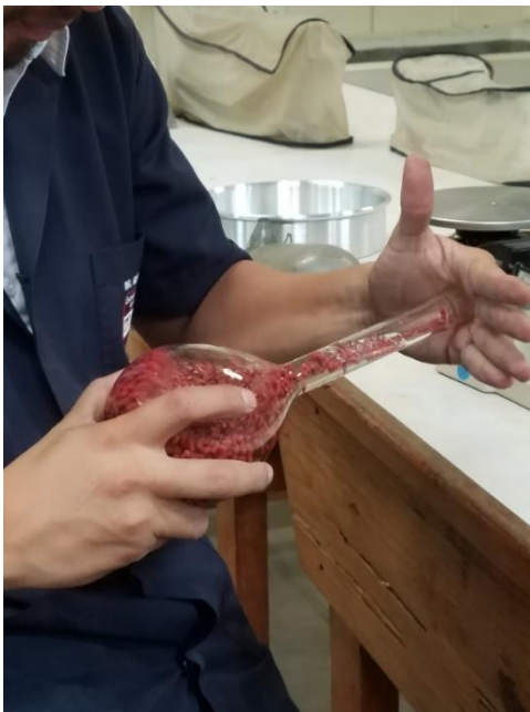
Figura 28. Se procede a desairar el picnómetro.
