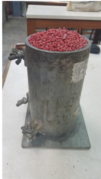
Figura 31. El molde se rellena con el material a fundir en el horno para unificarlo en el cilindro.
