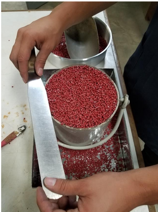
Figura 24. Al finalizar el llenado del molde se nivela la superficie del molde.
