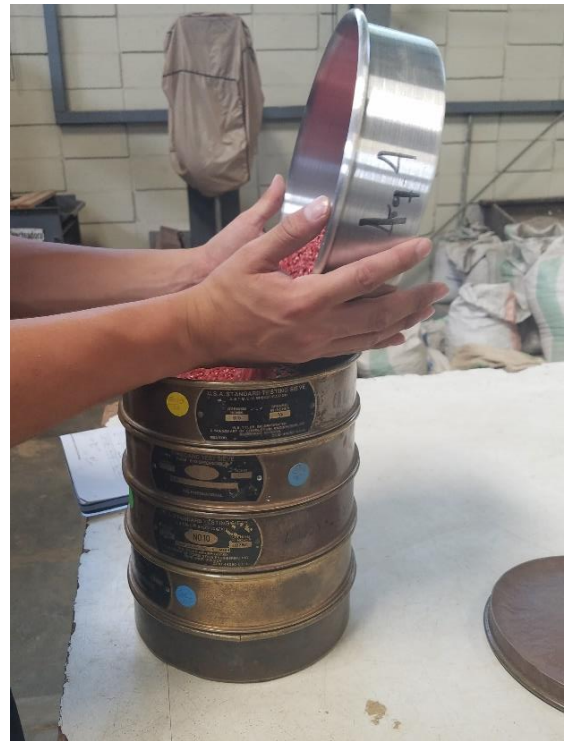
Figura 18. Colocación de material en tamices.
