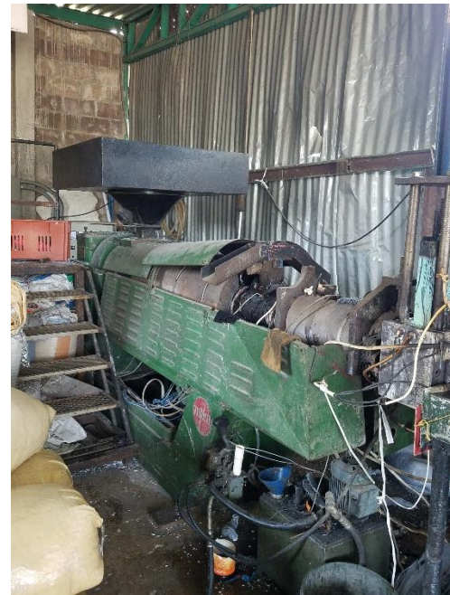
Figura 11 y 12. Cuando se ha secado el material, se lleva a la fase en la que se vierte en una tolva el plástico picado y luego va pasando por un tornillo sin fin en una maquina extrusora, a una alta temperatura que logra fundir el plástico.
