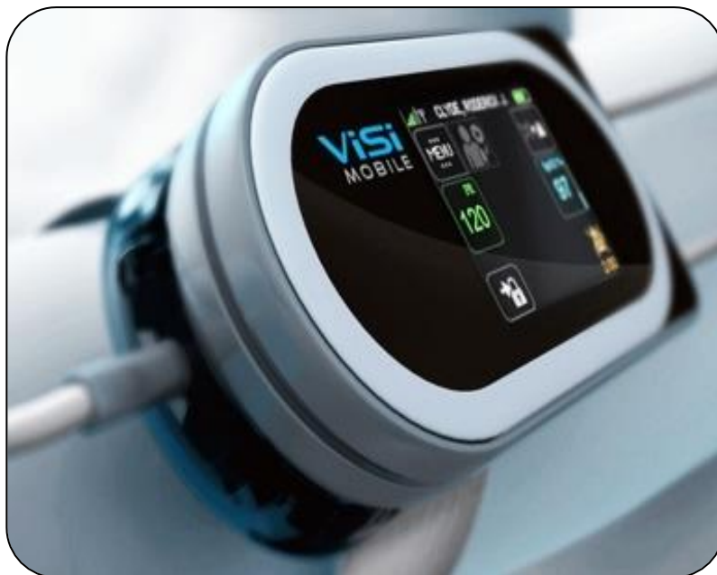
Figura 6. Imagen de un dispositivo VISI, utilizado para monitorizar el estado de salud y signos vitales de un paciente en tiempo real. Tiene la capacidad de sincronizarse con un dispositivo móvil.
