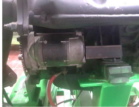
Instalación de motor de arranque.
