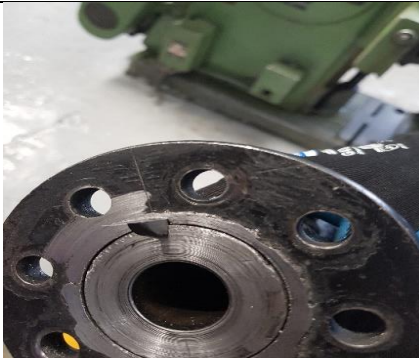
Fabricación de cuñero y soldadura de pieza.
