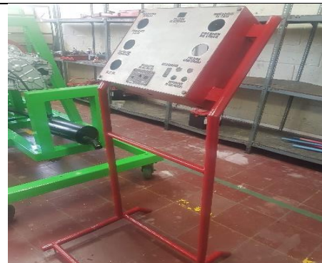
Preparación de tablero de control para instalación de marcadores.
