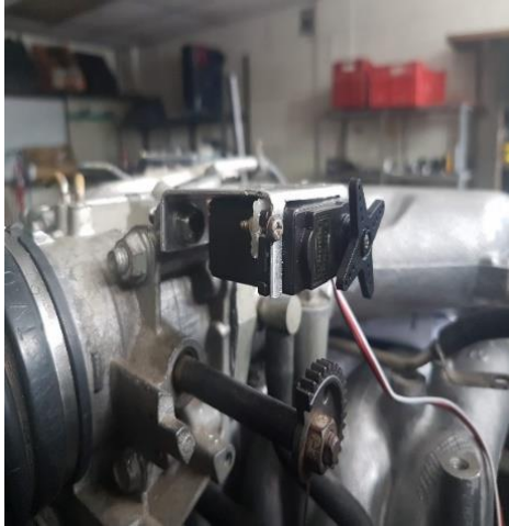
Instalación de motor eléctrico para aceleración de M.C.I.
