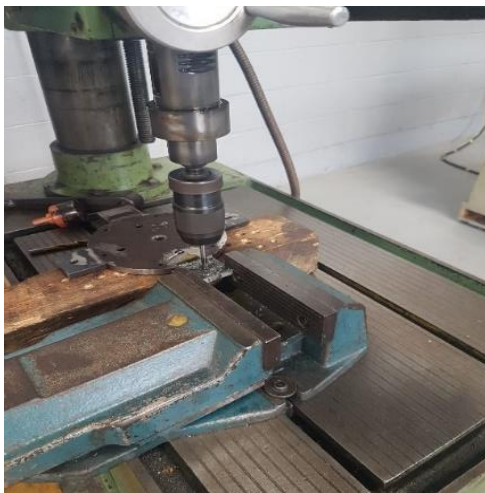
Fase final de maquinado de disco sujetador.
