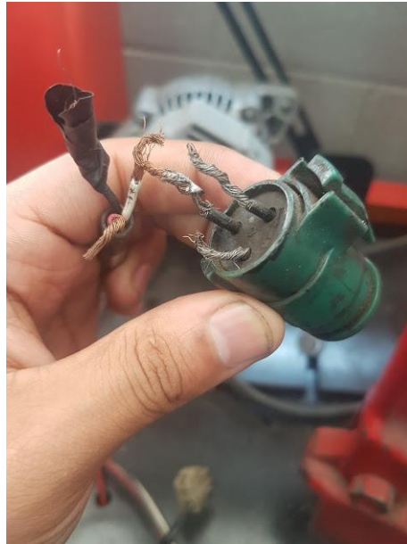
FIGURA20.1 Restauración de conectores de alternador
