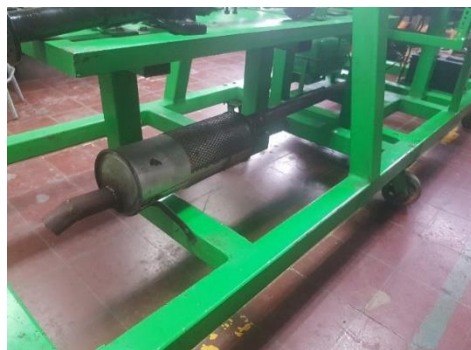
Proceso de cortes trazo y medición de tubo de escape para soldar e instalar en banco.
