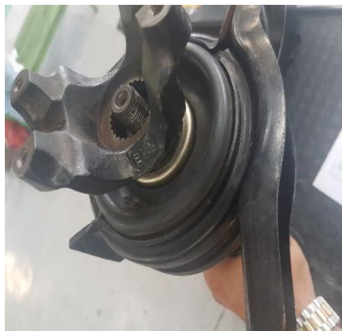
Instalación de soporte cardánico.
