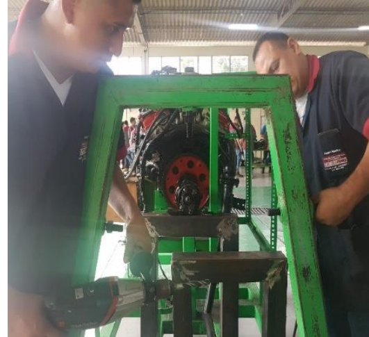
Instalación de tornillos sujetadores.
