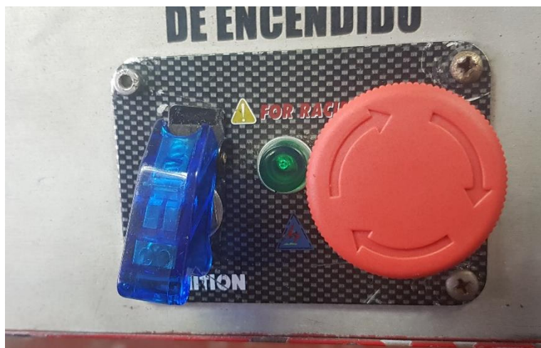
Fig. 31. Botón de paro de emergencia instalado en el banco probador
