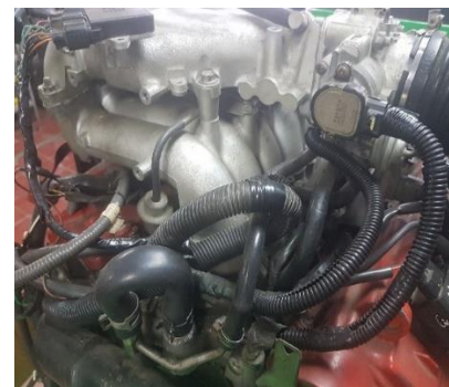
Instalación de aislantes eléctricos y coraza de protección a ramal.
