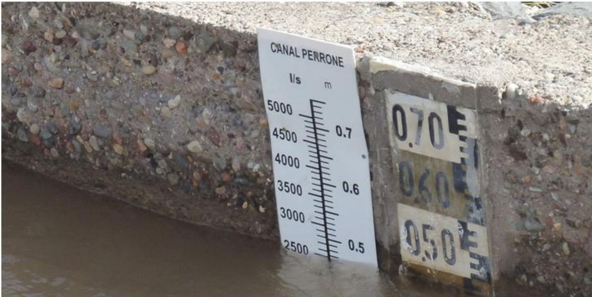
Fig. 6 Sensor por inmersión, utilizando regla telemétrica.
