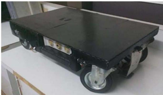
Prototipo de Vehículo Guiado Autónomo construido.
