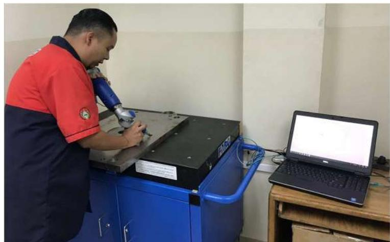
Docente Investigador verificando placa de molde mecanizada.
