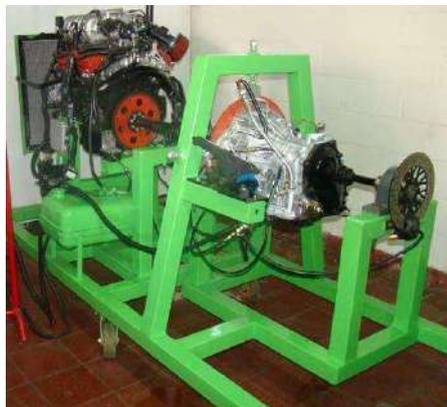
Equipo probador de cajas de transmisión automática de vehículos automotores.
