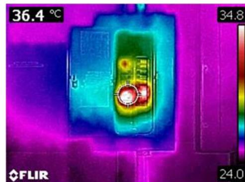
Termografía muestra calentamiento en un tablero.
