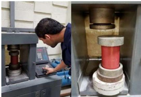
Probeta de plástico reciclado ensayada en Máquina de Compresión
