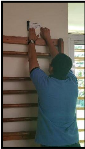
Figura 31. Colocación de dispositivos medidores de temperatura y humedad relativa. Fuente: fotografía propia, 2019.
