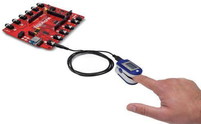
Fig. 31. Conexión y medición de variable biométrica SpO2 y pulso.
