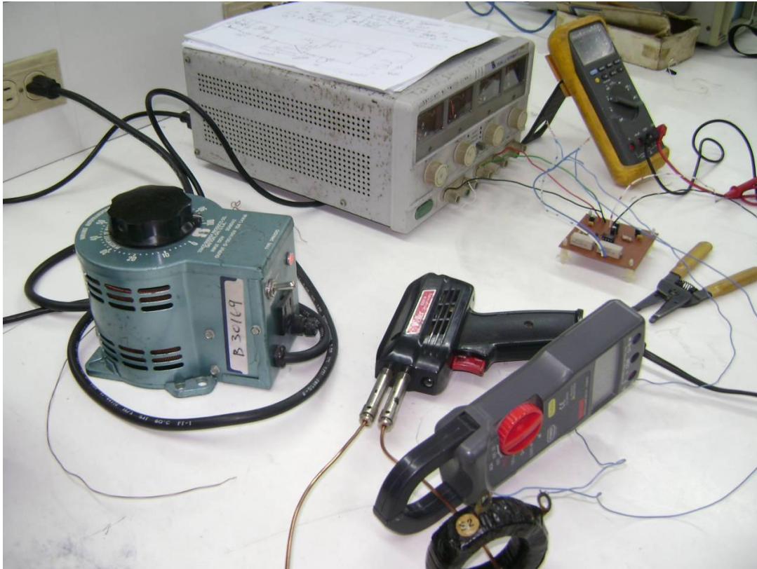
Fig. 2. Pruebas de circuito de medición de corriente.
