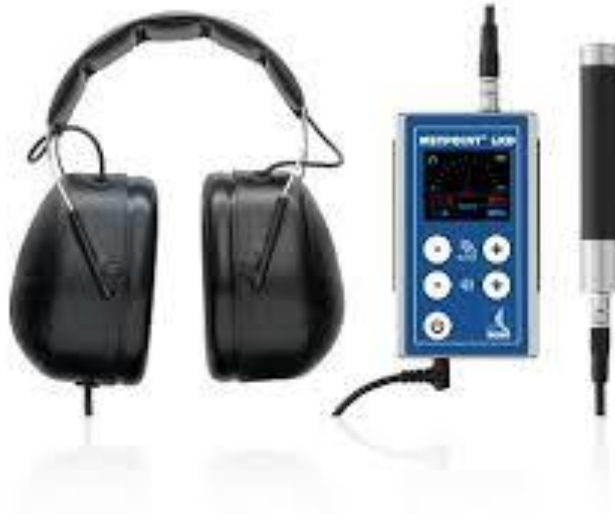
Fig.7 Sensor de ultrasonido para detectar fugas en lugares silenciosos
