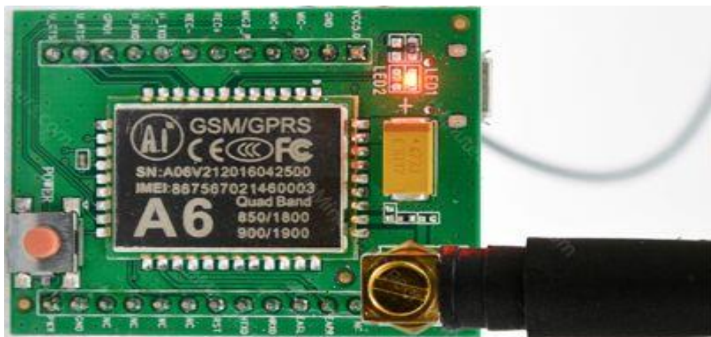
Fig. 22: Módulo A6 GSM/GPRS.
