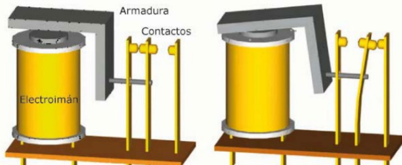
Ilustración 28: representación de un relé desconectado y un relé conectado
