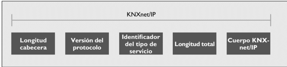
Ilustración 14: estructura de telegrama en KNXnet/IP.
