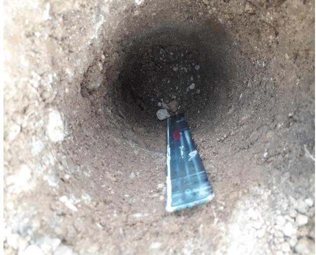
Figura 7.2. Medición del agujero, del cual, se extrajo la muestra de tierra para análisis.
