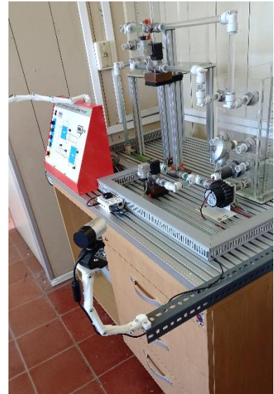
Fig. 23: Case de protección para el servidor basado en Raspberry Pi y Brazos ajustables para las cámaras de video.
