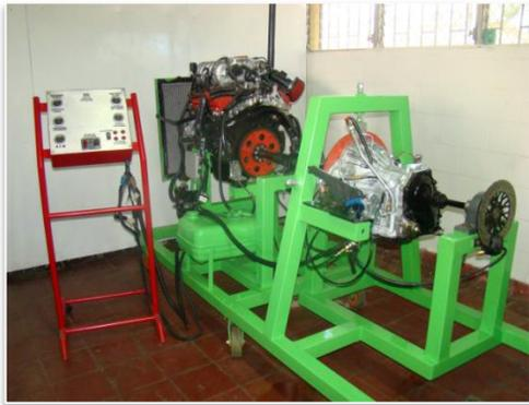
Figura 3. Banco con motor de combustión interna V6 (seis cilindros en V).
