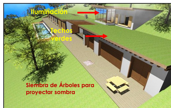
Figura 1. Ejemplo de Diseño Bioclimático, aprovechamiento de iluminación, ventilación y techos verdes.
