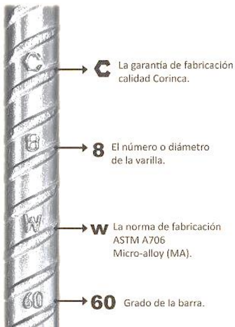
Imagen 24. Varilla corrugada requerimientos de calidad. Fuente. Corinca, El Salvador. 2022
