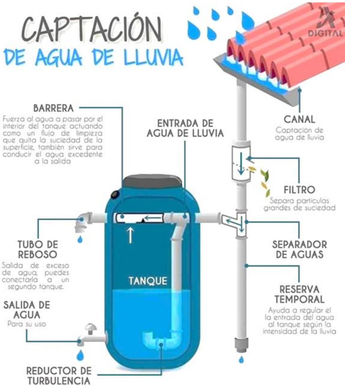
Imagen 10. Sistema de captación de aguas lluvias.
