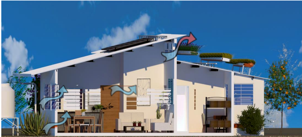
Imagen 49. Ventilación natural asistida por efecto chimenea.
