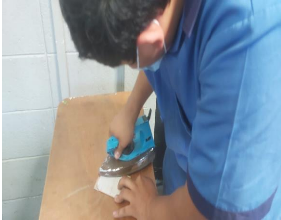
Planchado de circuito eléctrico.
