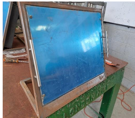
Instalación de lamina y manecillas en panel.
