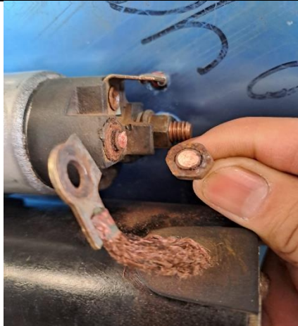
Daño de borne positivo del motor.
