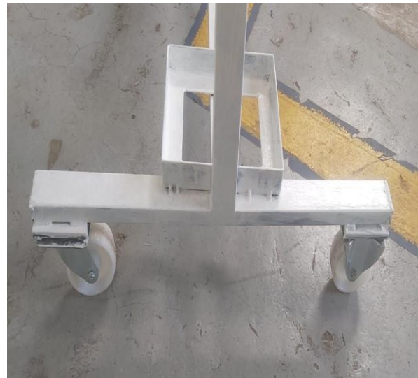
Diseño de estructura porta batería.
