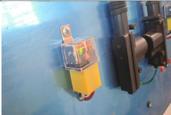
Prueba de relevador conmutador 5 terminales.
