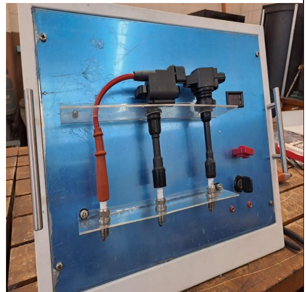
Instalación de bobinas de encendido en panel metálico.
