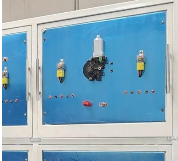
Prueba de motor sube vidrios.
