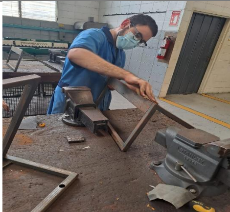
Lijado de paneles.
