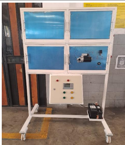
Instalación de panel de motor de arranque.
