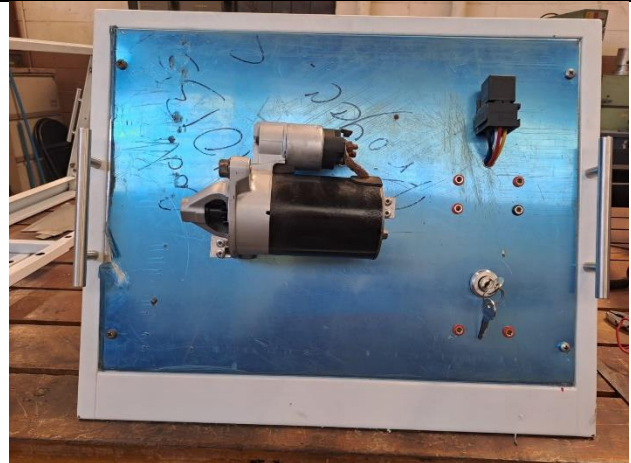
Armado de circuito de motor de arranque.
