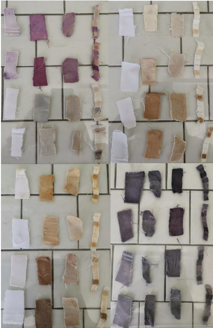
Figura 71. Muestras de textiles tinturados con extractos de bayas secas después de las pruebas de secado. Fuente: Elaboración Propia.
