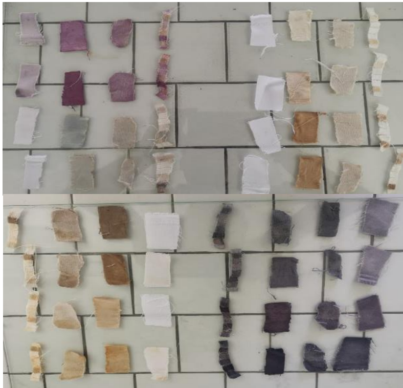
Figura 74. Muestras de textiles tinturados con extractos de bayas secas para prueba de luz. Fuente: Elaboración Propia.
