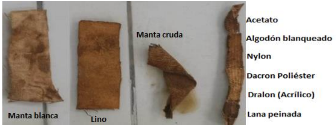
Figura 48. Fibras teñidas con extracto de NaOH de bayas frescas con \text{FeSO}_4 como mordiente. Fuente: Elaboración Propia.
