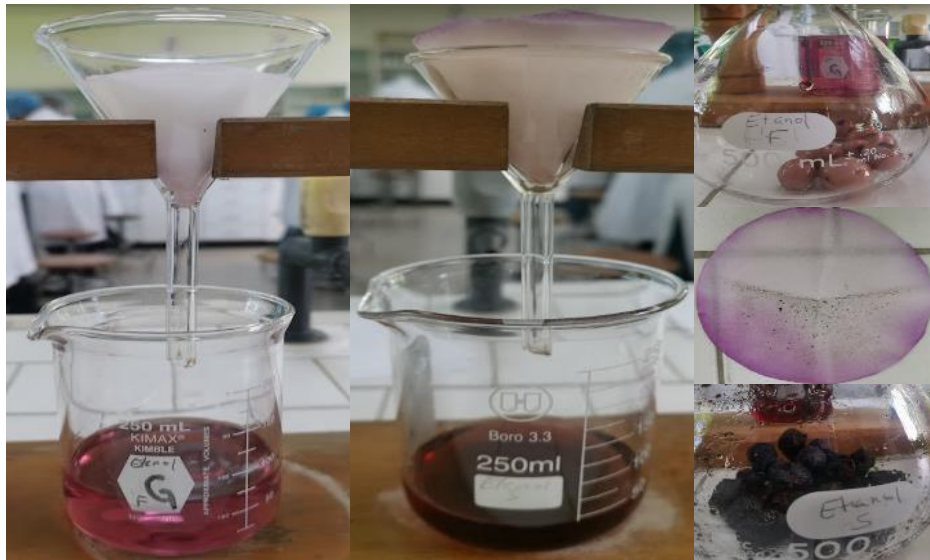
Figura 15. Proceso de filtración de la maceración alcohólica de las bayas frescas y secas.
