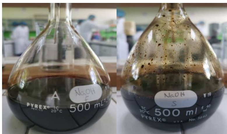
Figura 11. Maceración con hidróxido de sodio de bayas frescas (izq.) y bayas secas (der.). Fuente: Elaboración Propia.
