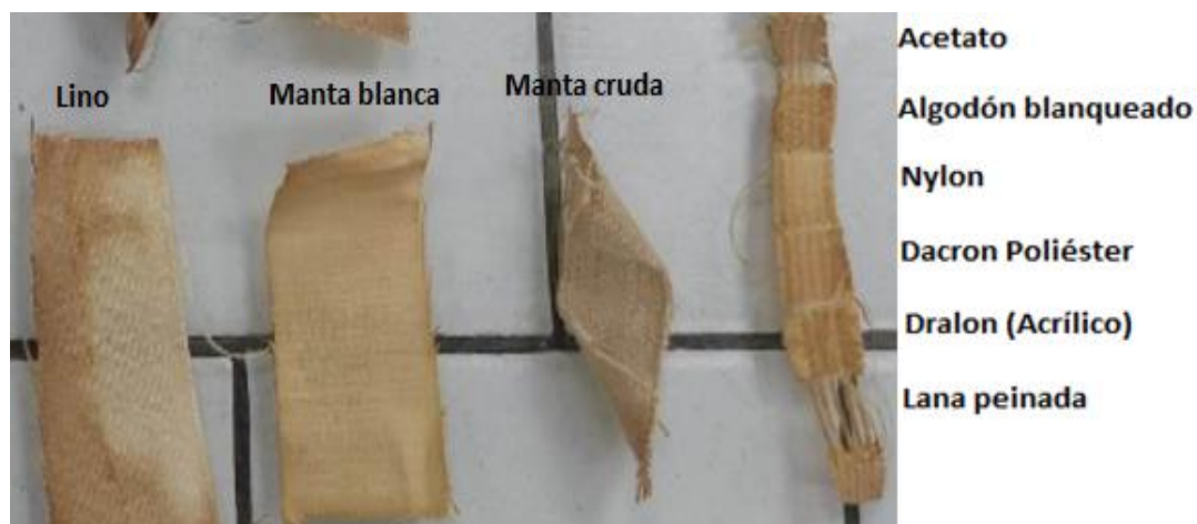
Figura 40. Fibras teñidas con extracto de NaOH de bayas frescas con NaCl como mordiente. Fuente: Elaboración Propia.
