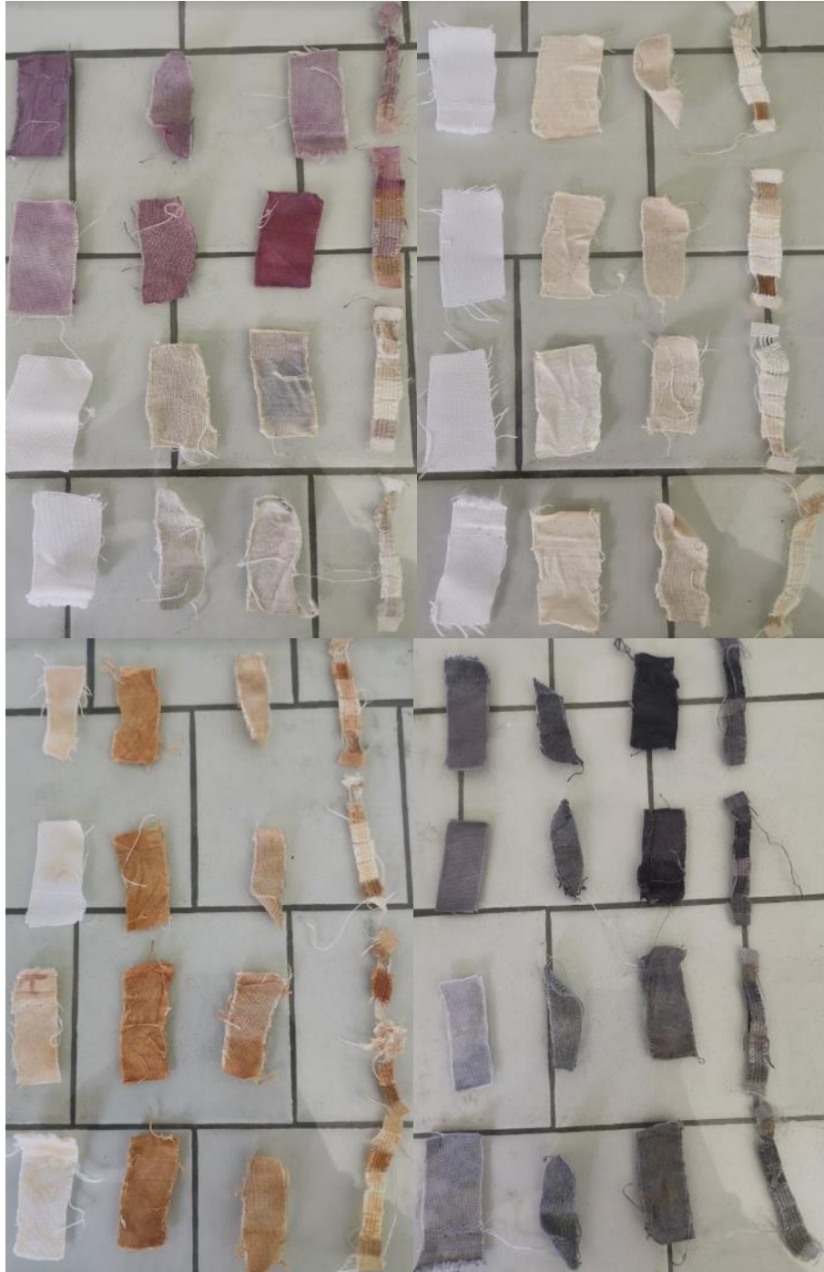
Figura 70. Muestras de textiles tinturados con extractos de bayas frescas después de las pruebas de secado. Fuente: Elaboración Propia.
