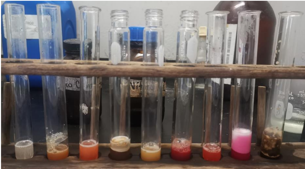
Figura 25. Resultado de los colores obtenidos en los extractos con la prueba de identificación de flavonoides. Fuente: Elaboración Propia.
