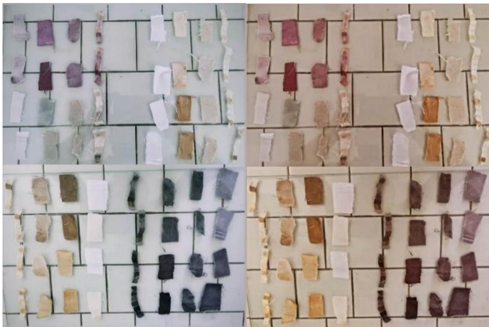
Figura 75. Textiles tinturados con extractos de bayas secas expuestos a luz blanca (izq.) y luz amarilla (der.). Fuente: Elaboración Propia.
