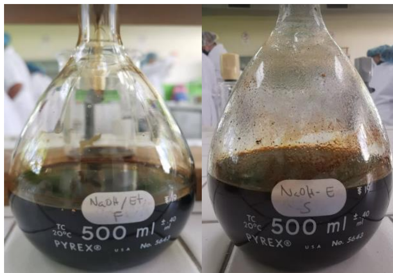
Figura 13. Maceración con NaOH/etanol de bayas frescas (izq.) y bayas secas (der.). Fuente: Elaboración Propia.
