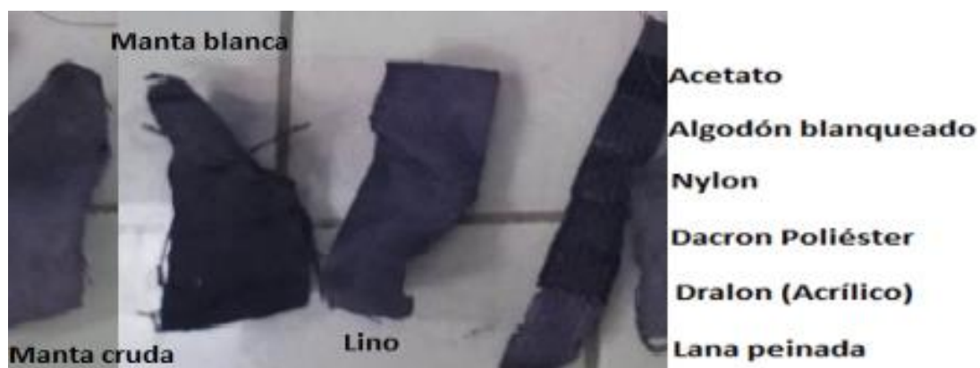
Figura 57. Fibras teñidas con extracto de etanol de bayas secas con NaCl/FeSO 4 como mordiente. Fuente: Elaboración Propia.
