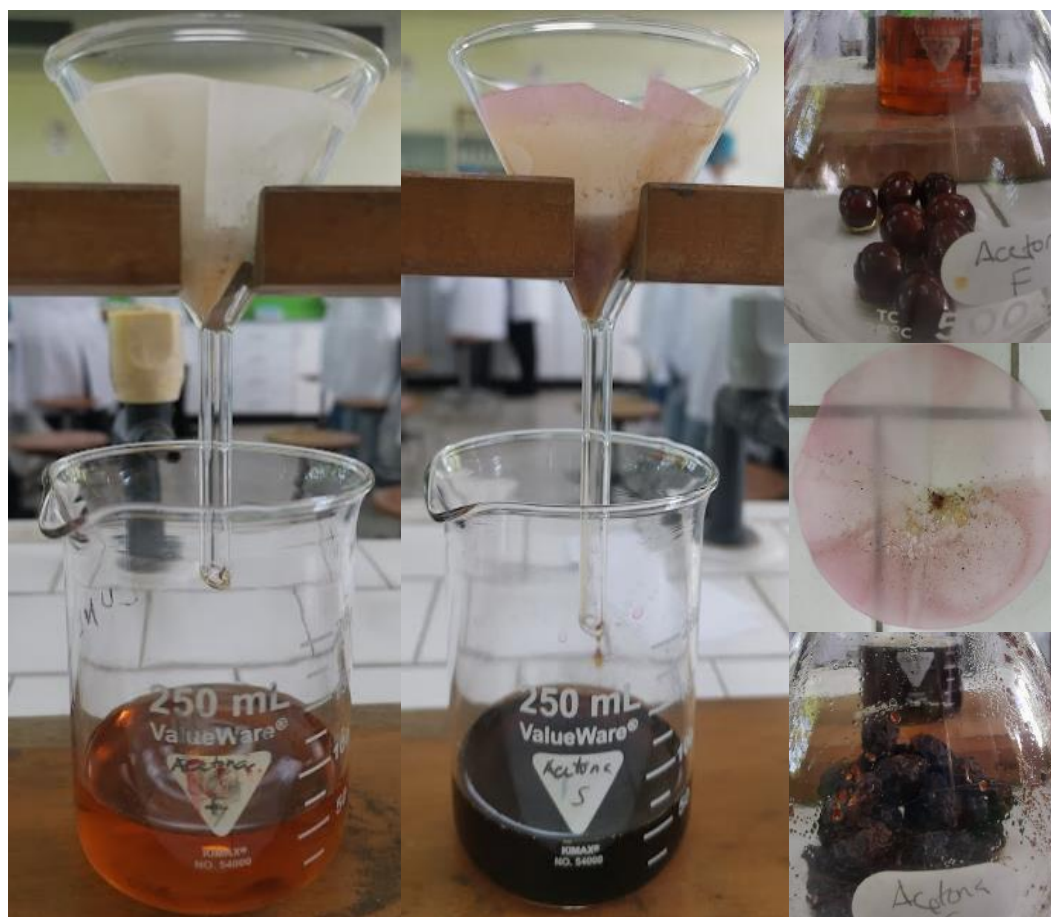
Figura 17. Proceso de filtración del extracto de acetona de las bayas frescas y secas.
