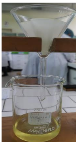
Figura 19. Proceso de filtración de la maceración hexano/acetona/etanol de las bayas frescas. Fuente: Elaboración Propia.
