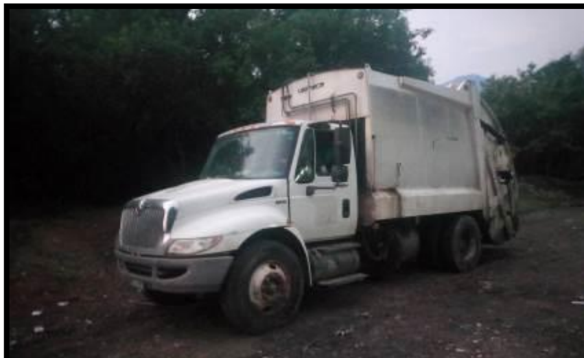
Ilustración 4. Vehículo compactador International utilizado para la recolección de desechos sólidos.
