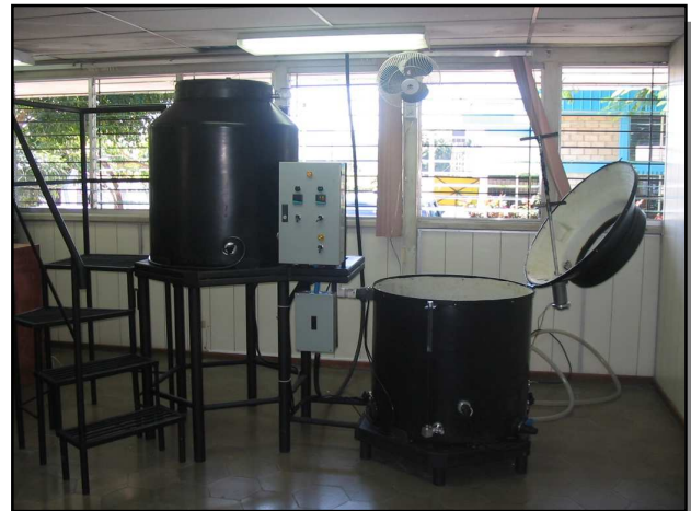
Máquina para producir tinte orgánico a base de añil.
