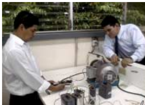
Realización de pruebas de balance de corriente y voltaje entre líneas
