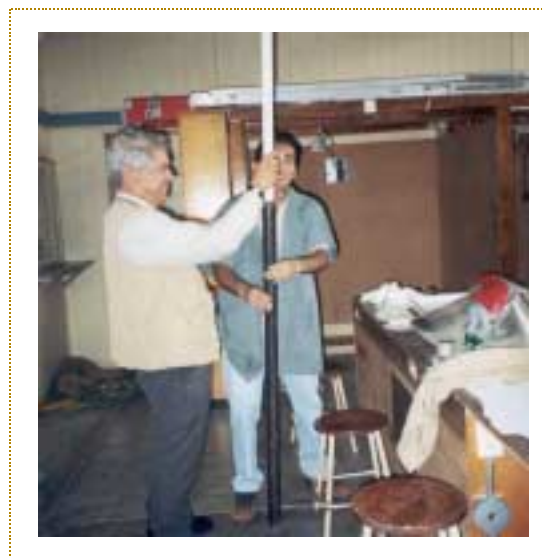
Realización de pruebas de extracción del mercurio contenido en lámparas desechadas.
