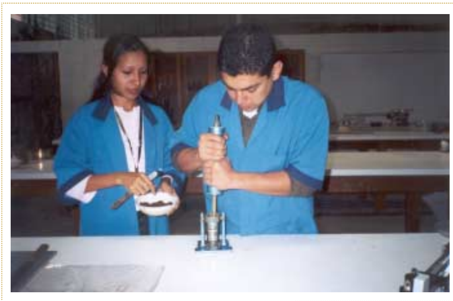
Realización de ensayos de laboratorio a muestras de suelo arcilloso estabilizado con melaza de caña de azúcar.
