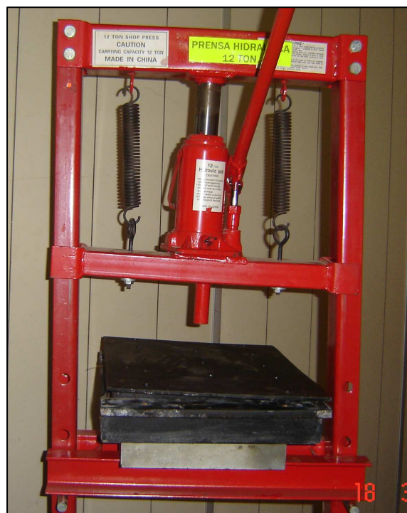
Máquina prensa para compactación de la fibra de coco en molde
