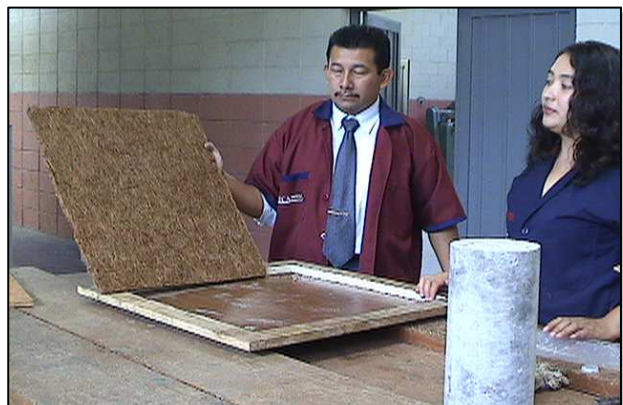
Primeras pruebas de fabricación de losetas para cielo falso con fibra de coco
