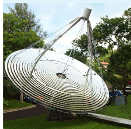
Concentrador Solar Térmico instalado en campus de la UDB en Ciudadela Don Bosco.
